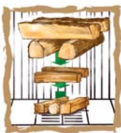
Befeuerungselement unter dem Scheitholz positioniert
