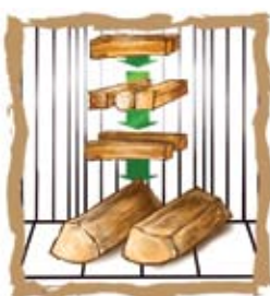
Befeuerungselement auf dem Scheitholz positioniert
